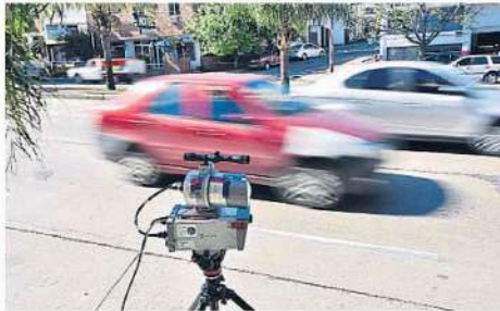
Equipos. Permiten detectar vehículos en infracción y registrar las velocidades de circulación.
